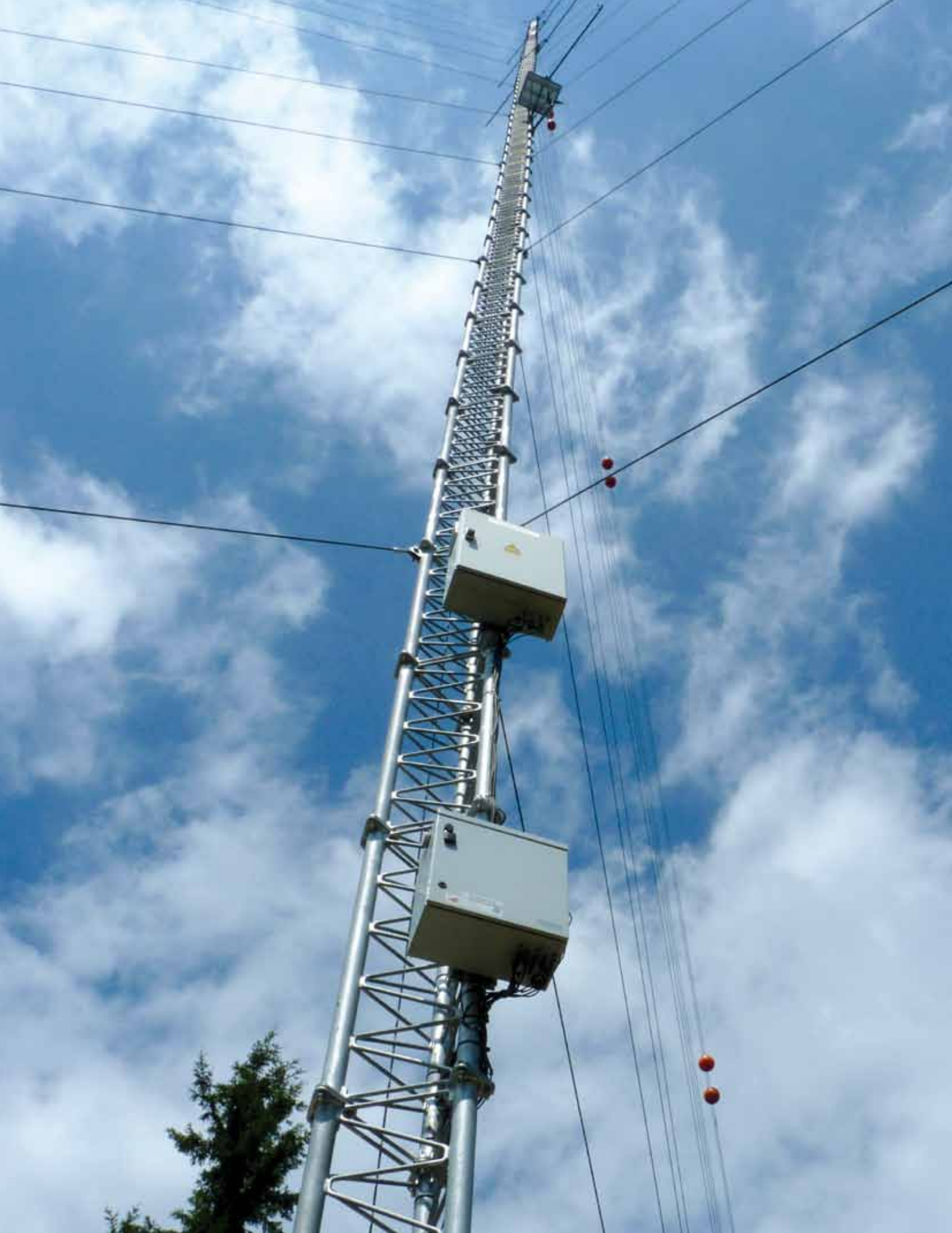
Windmessmast an einem Waldstandort mit Fledermausdetektoren.
